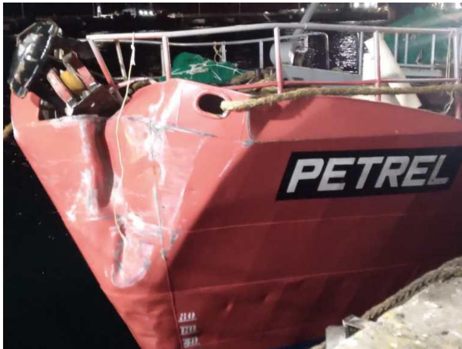
Figura 13. Daños posteriores a la colisión del B/P Petrel
