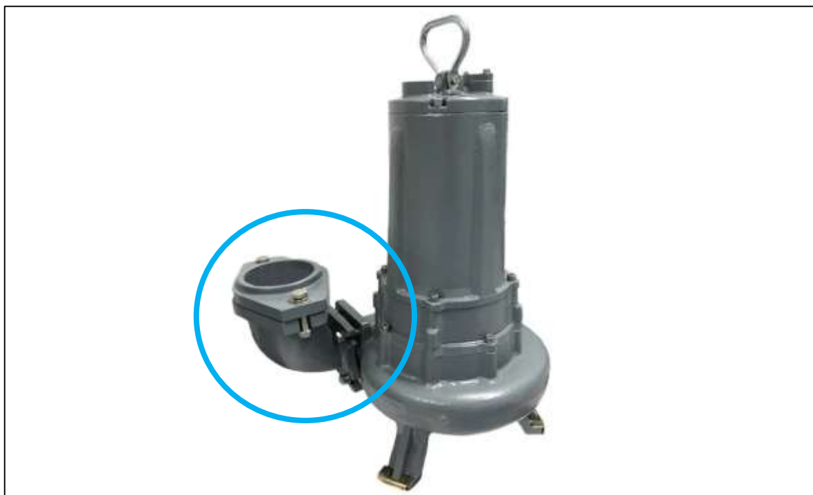
Figura 8. Bomba eléctrica sumergible Czerweny modelo 100WQ3,7-4P. Se observa, resaltada en el círculo, la pieza metálica del codo de descarga que se averió, y que va acoplada al cuerpo metálico de la bomba
