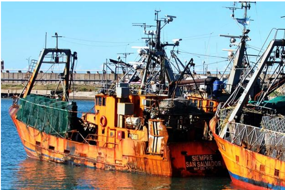
Figura 3. Siempre San Salvador visto de su aleta de babor. Se observa en la cubierta de la timonera la balsa de babor y sobre la cubierta principal, en el lado de babor, la troja de cajones vacíos.
