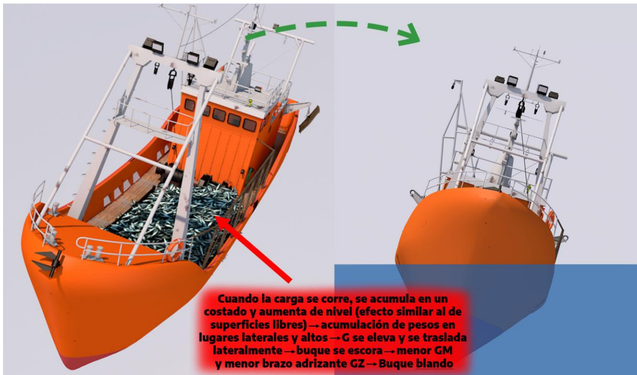
Figura 16. Imágenes de la variación de G, GM y GZ por escora debido a corrimiento de pesos
