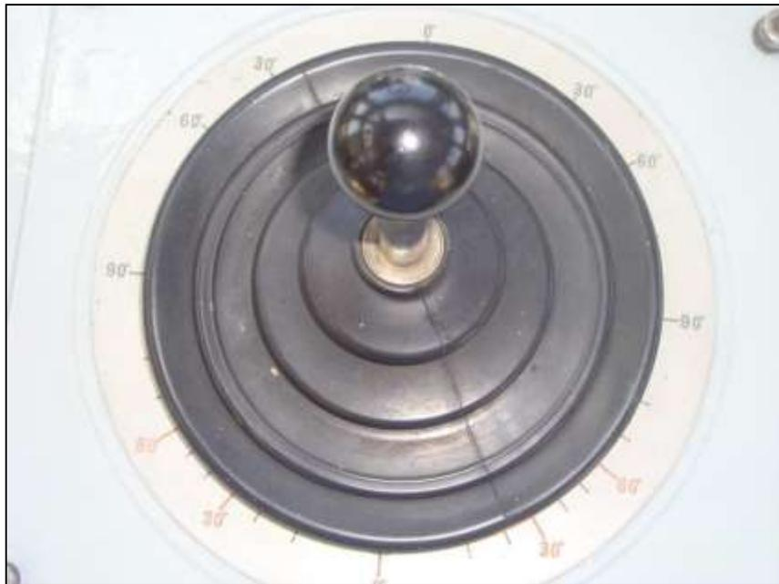
Figura 12. Palanca de mando, sistema monocomando. Fuente: material documental
