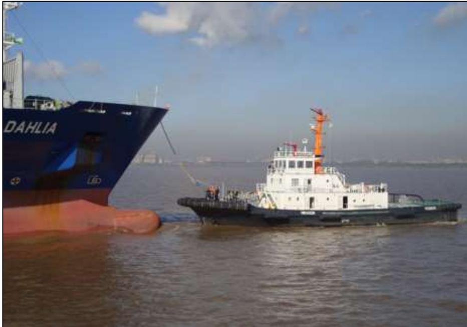
Figura 17. Remolcador navegando hacia popa tomando el cabo de remolque del buque. Fuente: material documental
