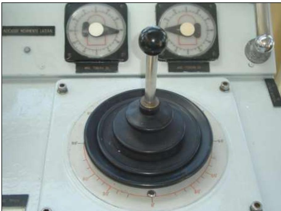
Figura 11. Sistema de monocomando. Se observan en la parte superior de la imagen los indicadores que muestran la orientación de las toberas y, al centro, el comando unificado para su orientación.
