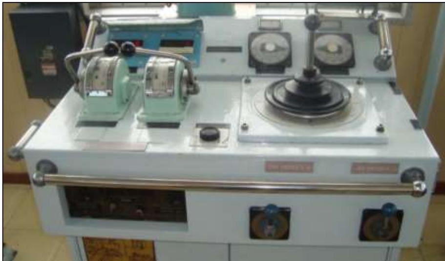
Figura 10. Consola del sistema de monocomando. Se observan a la izquierda los comandos de aceleración para cada hélice y, a la derecha, el comando unificado para la dirección de las toberas.
