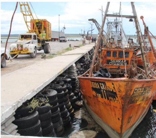
Figura 9. Frente de atraque. Cubiertas de automotor como defensas.
