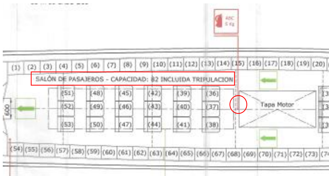
Figura 18. Plano de seguridad. Vista en planta. Nótese la capacidad de 82 personas incluida la tripulación y la ubicación del extintor más próximo al motor y a popa de este.
