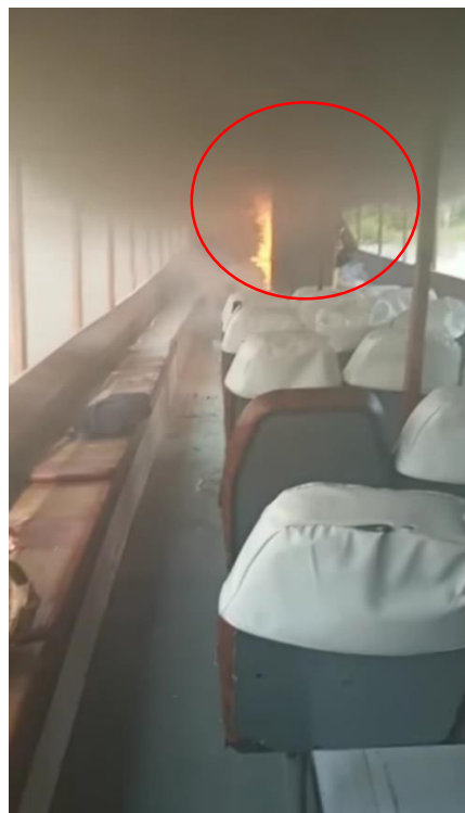
Figura 3. Foto del interior de la lancha vista desde popa hacia proa. Notar las llamas en el recubrimiento de madera del sistema de exhaustación.
