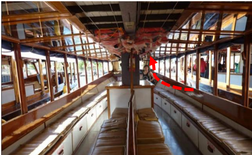
Figura 12. Imagen de la ubicación de los salvavidas en condiciones normales. Nótese que las ventanas al abrirse impiden el acceso a algunos salvavidas.
