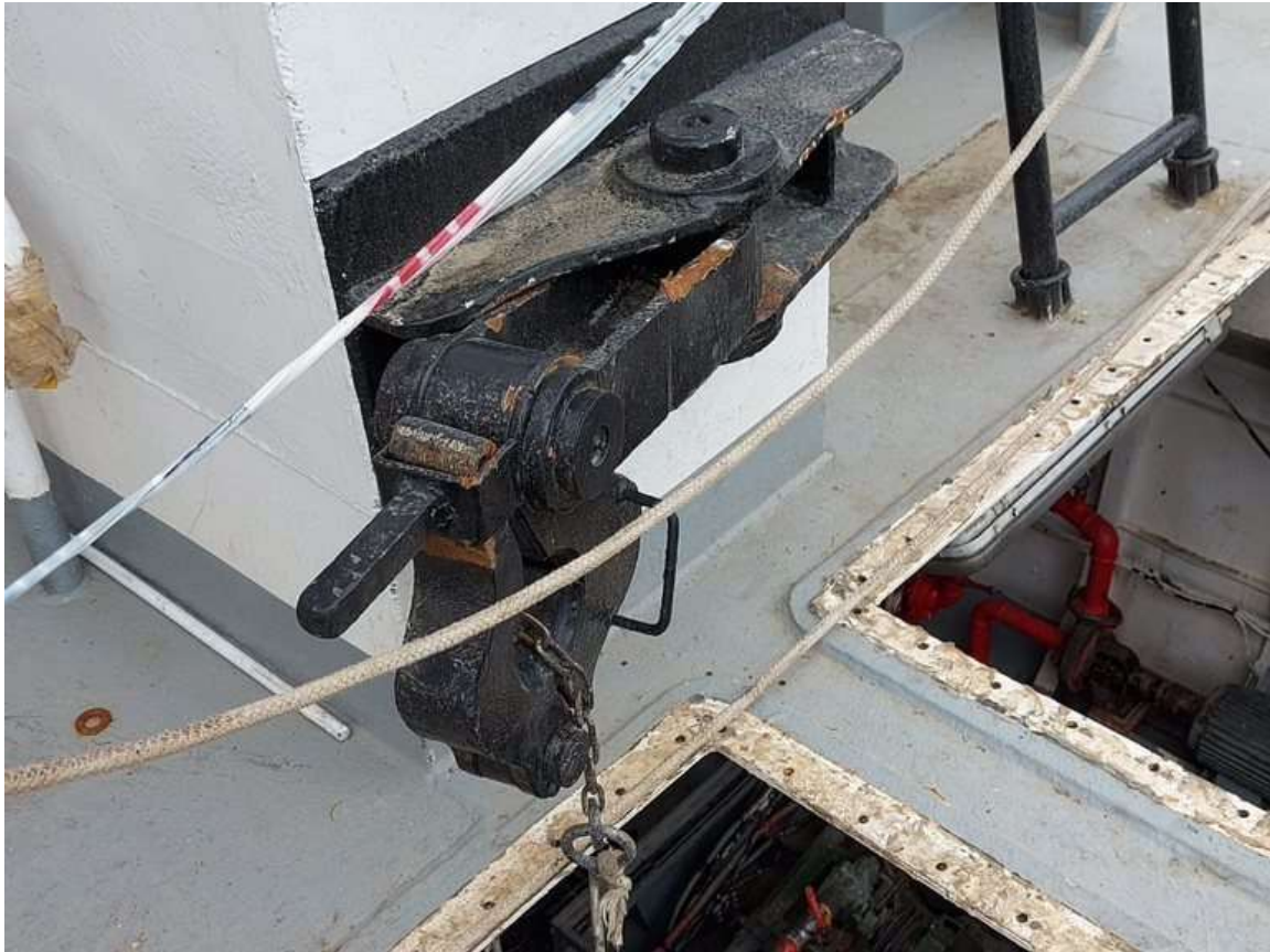
Figura 2: Gancho utilizado por la LM Gipsy V en la maniobra de asistencia al amarre.
