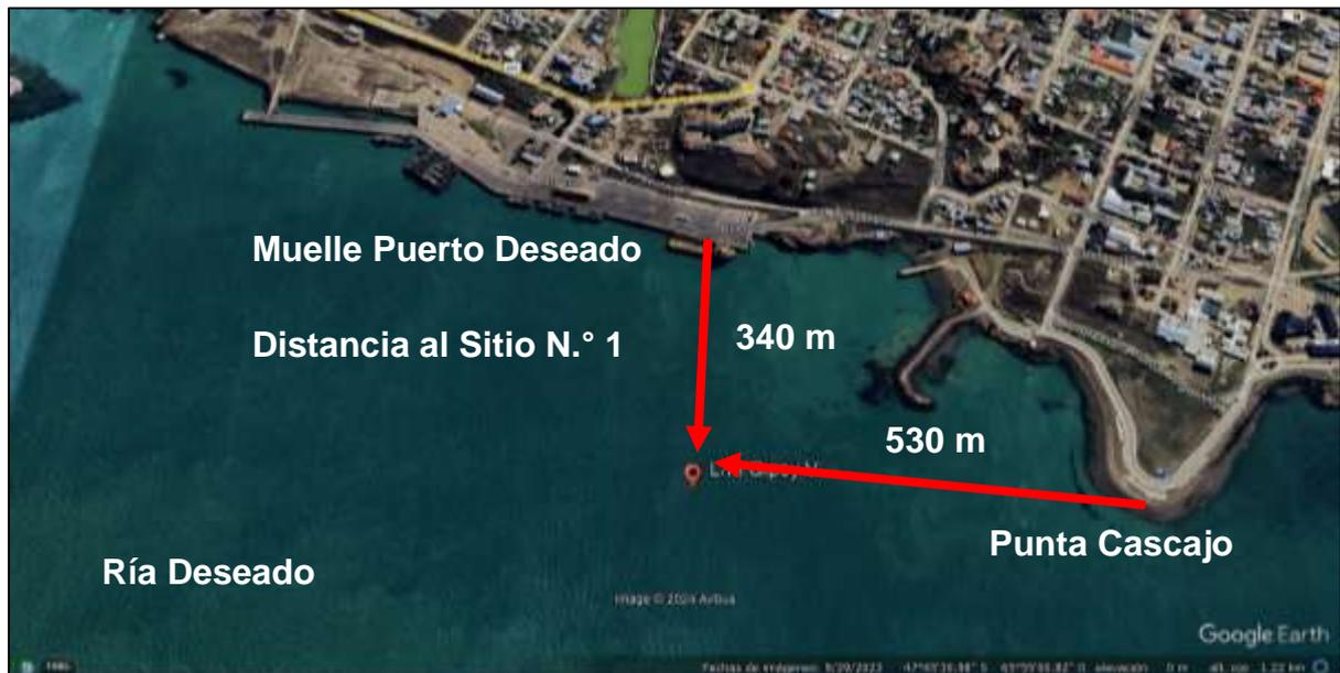
Figura 1. Ubicación del hundimiento. Se observa el frente de atraque del muelle de Puerto Deseado, con una longitud total de 739 m. Consta de 4 frentes con anchos de 17 m a 30 m y una superficie total de 15.000 m<sup>2</sup>. Operan buques de carga general que habitualmente alcanzan los 180 m de eslora. Las profundidades varían de 9 a 11 m. Fuente: Google Earth
