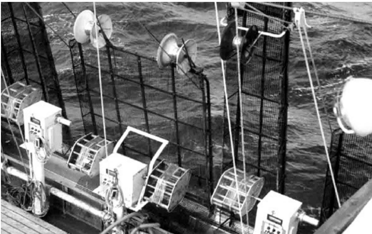
Figura 9. Se observan las máquinas automáticas, las parrillas y la canaleta colectora de la captura. Fuente: Artes y Métodos de Pesca Nivel III, Luis W Martini
