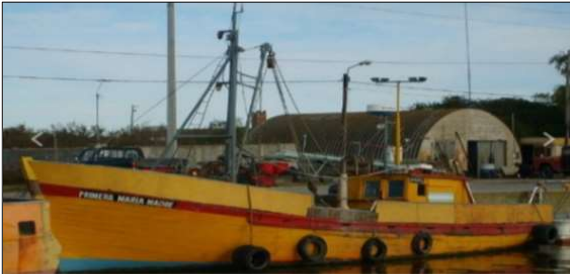
Figura 3. B/P Primera María Madre, visto por su costado de babor. Se observa un corte en la regala a la mitad de su eslora, lugar por donde se viraba la red a bordo. Fuente: material documental
