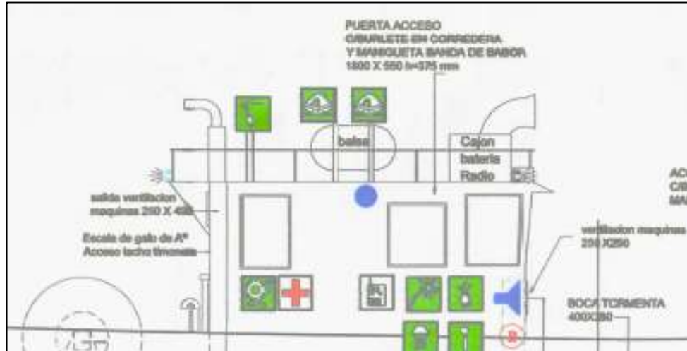
Figura 8. Se observa en el plano que la EPIRB y las dos balsas salvavidas (con capacidad de 4 personas cada una) estaban ubicadas sobre el techo de la timonera. Fuente: material documental
