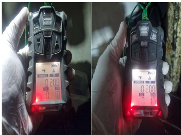
Figura 12. Medición de la atmósfera en bodega en puerto. Se observa un valor de H 2 S de 10 PPM
