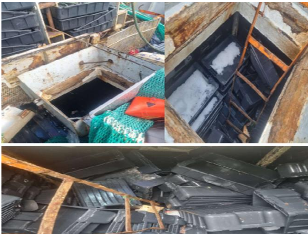
Figura 11. Acceso e interior de bodega. Notar el hielo en escama. Fuente: Material documental
