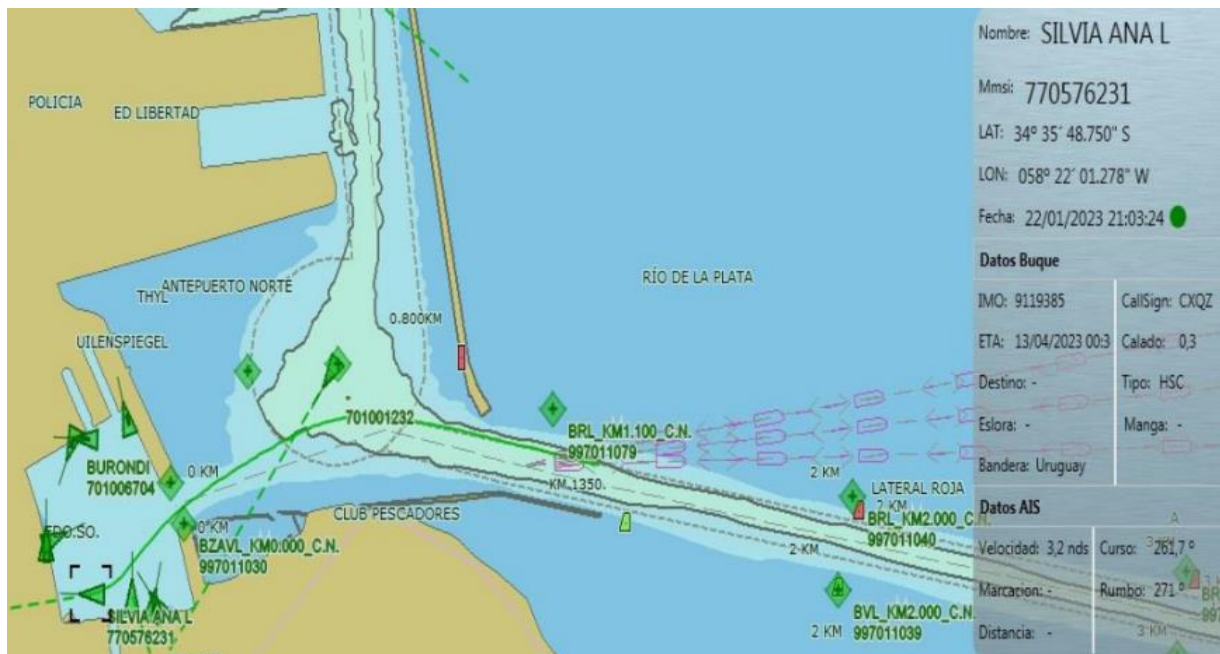
Figura 14: Se observa al Silvia Ana L aproximadamente en la posición del suceso a 18:03:24 con una velocidad de 3,2 nudos
