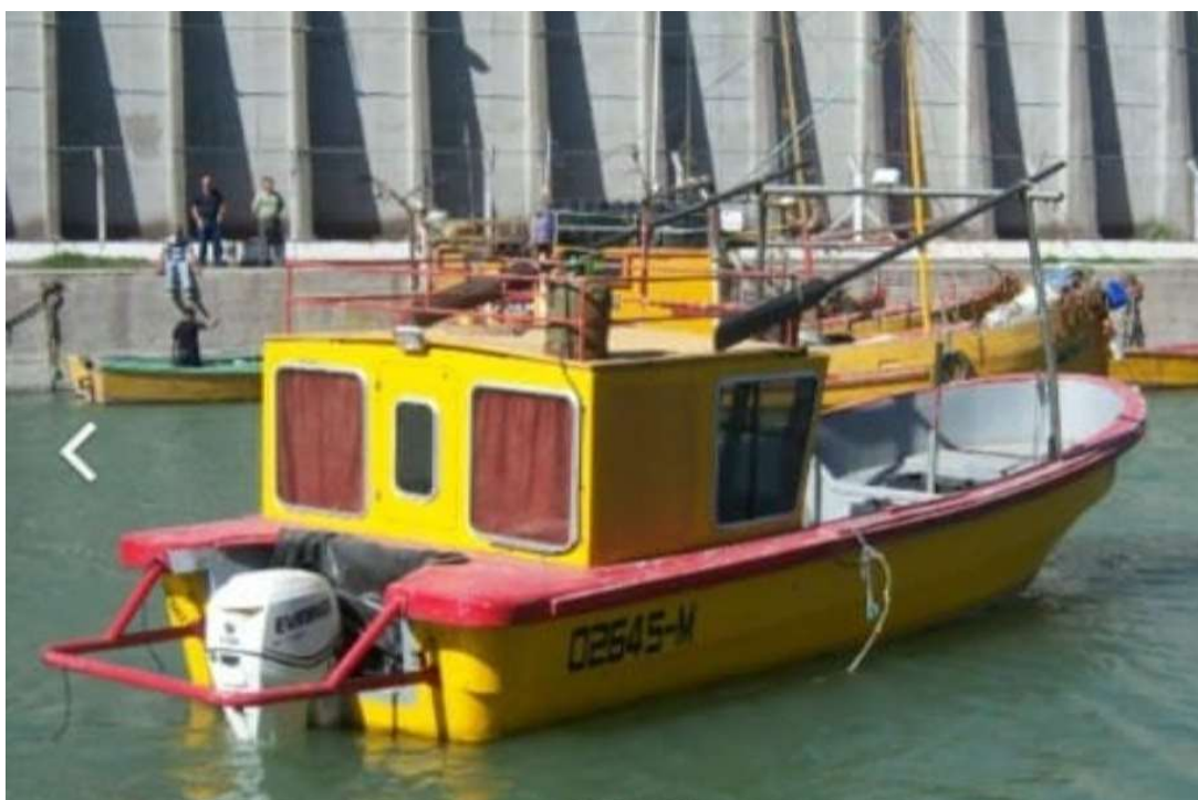
Figura 3: Lancha Motor Paola Andrea visto de su aleta de estribor. No se observa a la vista EPIRB, balsa ni aro salvavidas.
