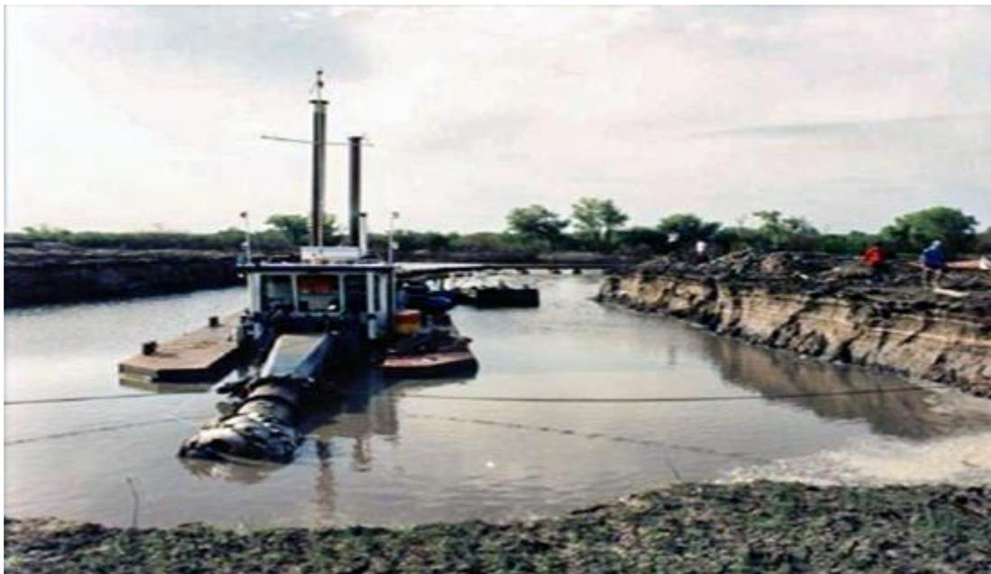
Figura 6. Imagen ilustrativa de la draga Elepele III. Se observa la escalera de dragado en la proa
