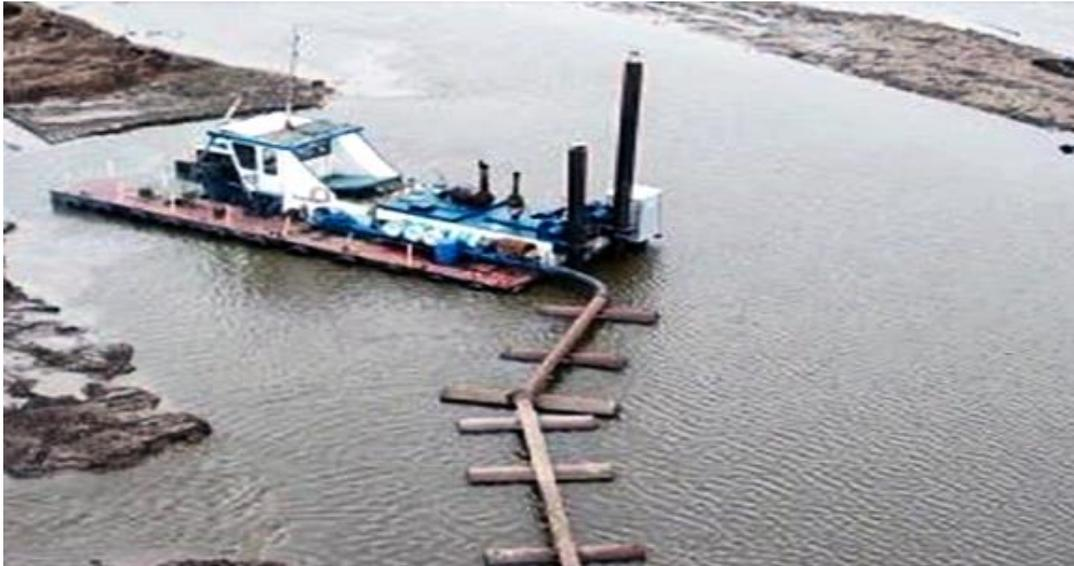
Figura 5. Imagen ilustrativa del artefacto naval tipo draga Elepele III en operación con tuberías flotantes. Se observan los pilotes de fondeo en la popa
