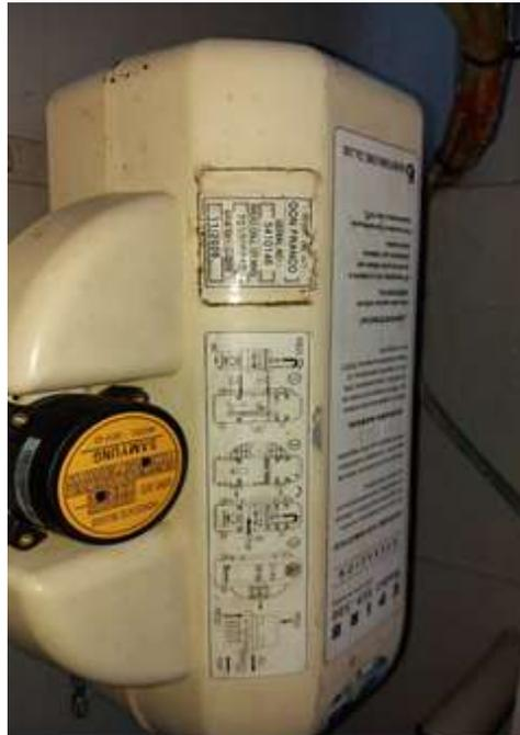
Figura 17. Radio baliza EPIRB ubicada en popa, sobre la cubierta de casillaje
