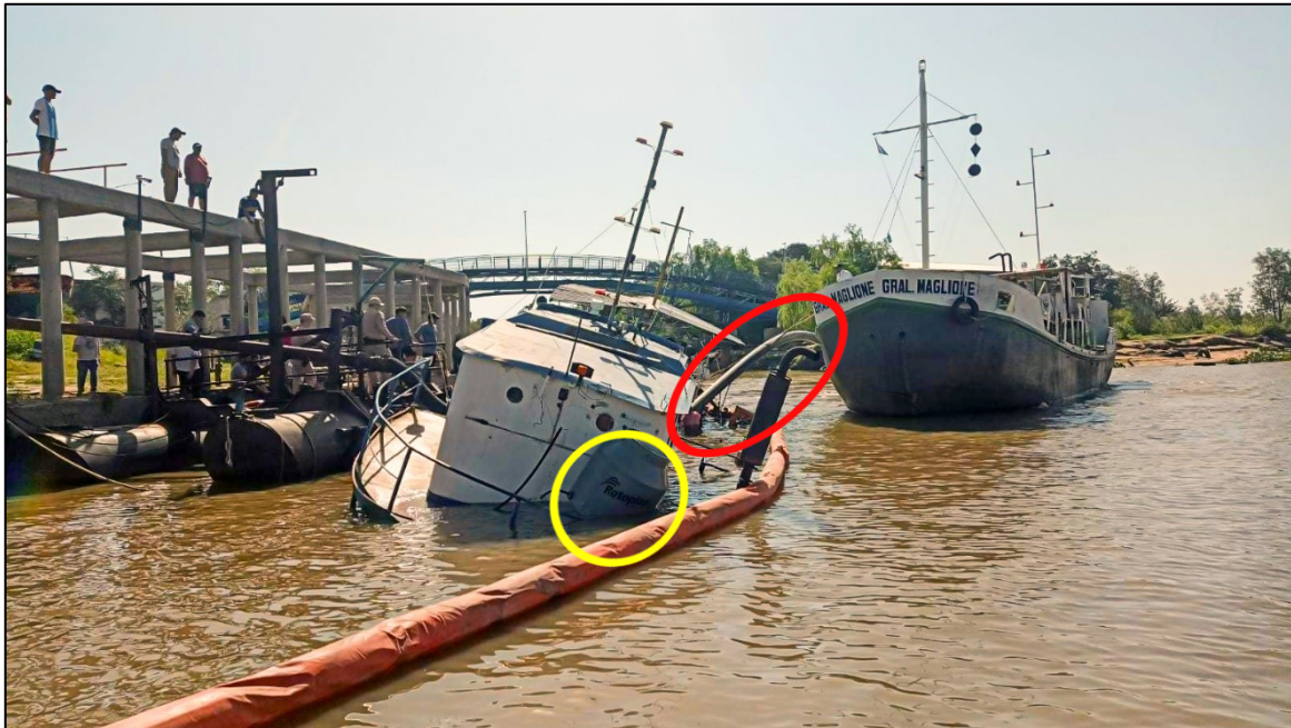
Figura 19. Vista desde la popa del buque hundido, se observa la barrera de contención sobre su estribor, amarras pasadas a la costa, personas sobre la estructura de hormigón y una tubería de descarga conectada con el buque Gral. Maglione con el propósito de achicar la pileta del María del Carmen. Se resalta además un tanque de agua instalado sobre la cubierta del puente de navegación (un nivel superior a la cubierta principal), en la aleta de estribor
