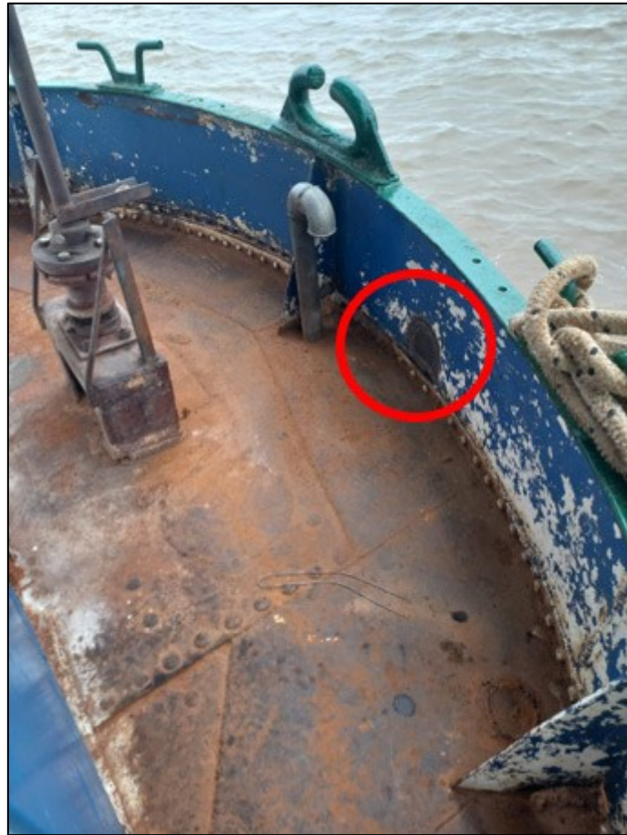
Figura 14. Se observa un desagüe clausurado en la popa. Estaba abierto al momento del suceso
