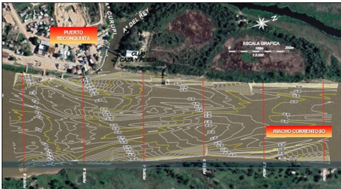
Figura 5. Relevamiento batimétrico del año 2022, correspondiente a un tramo del riacho Correntoso que abarca el frente del Puerto de Reconquista y de la desembocadura del arroyo del Rey
