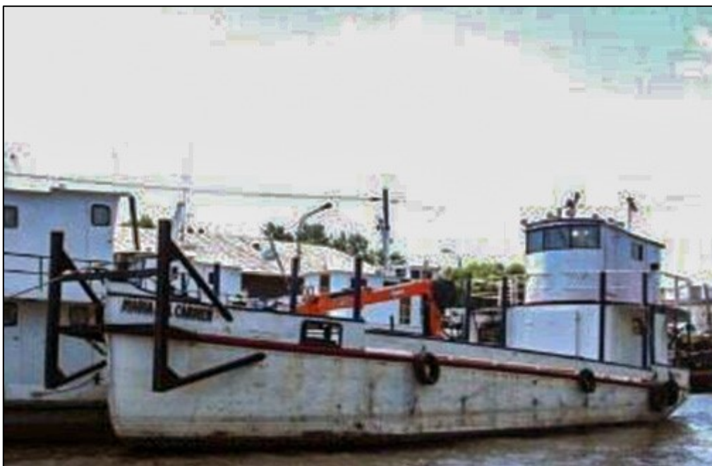
Figura 6. El B/M María del Carmen por su banda de babor. Foto antigua donde se observa que anteriormente tenía una estructura en la proa para el empuje de barcas
