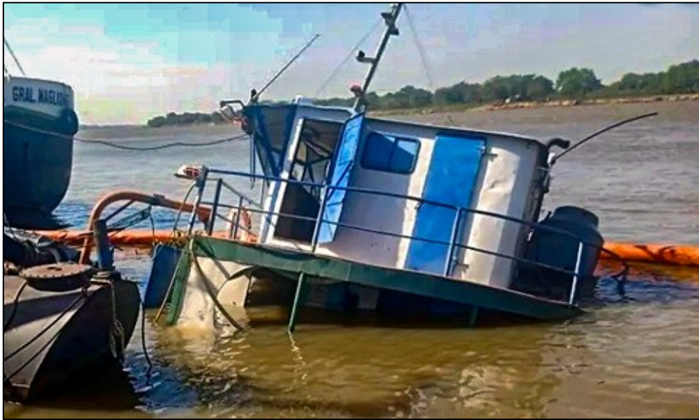
Figura 21. Vista del buque hundido por su banda de babor. Se observa la barrera de contención y la cubierta superior a la principal, cubierta del puente de navegación donde se aprecia un tanque de agua sobre estribor de ese nivel.
