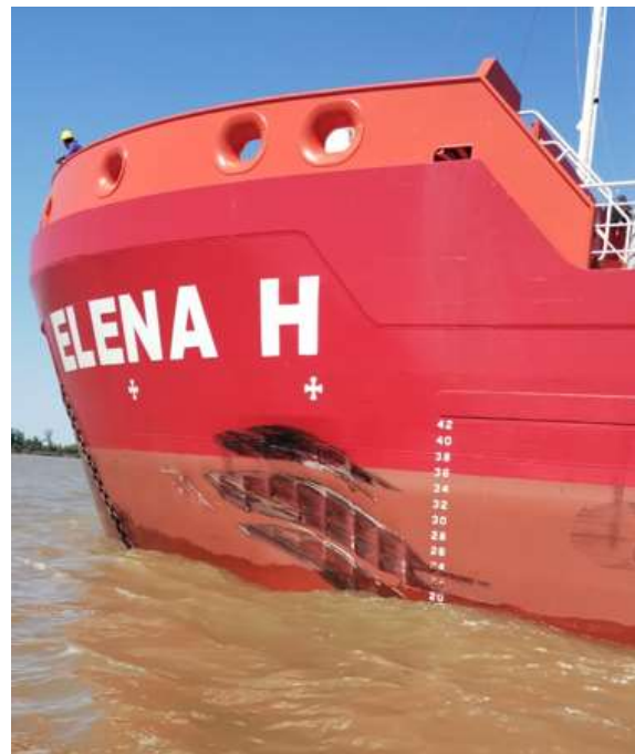
Figura 4. Fotos de los daños, a la izquierda el R/E Cavalier VI y a la derecha el B/T Elena H.
