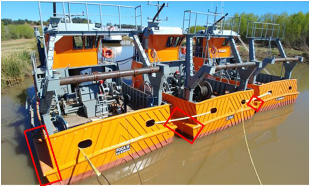
Figura 19. Buques gemelos Foca M, El Arca y El Tupamaro. Obsérvese resaltadas en rojo las reformas realizadas en el casco que aumentaron su manga para darle mayor flotabilidad. Fuente: material documental de investigación, DNISMFyL
