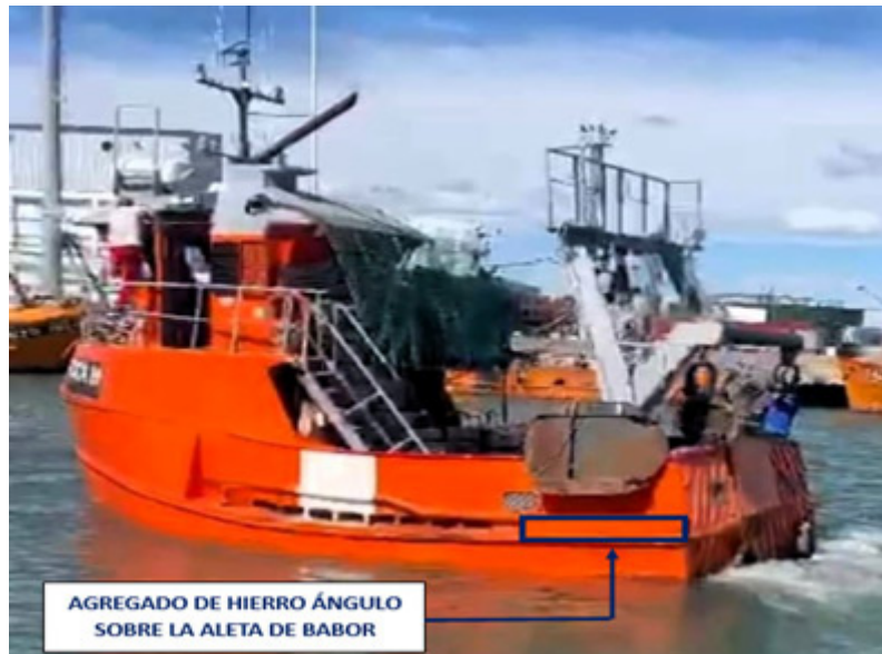
Figura 21. B/P Foca M con agregado de hierro ángulo sobre la aleta de babor
