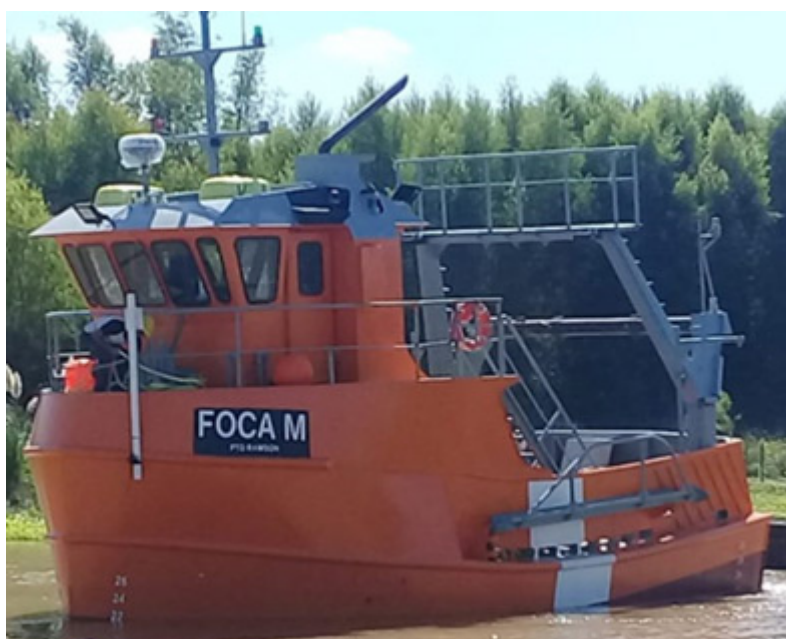
Figura 18. Foca M puesto a flote luego de reformas realizadas al diseño original (aumento de la manga del casco en el sector de popa por medio de un compartimiento estanco) que le dieron mayor flotabilidad en el sector de popa. Nótese la variación en el asiento (aproamiento).
