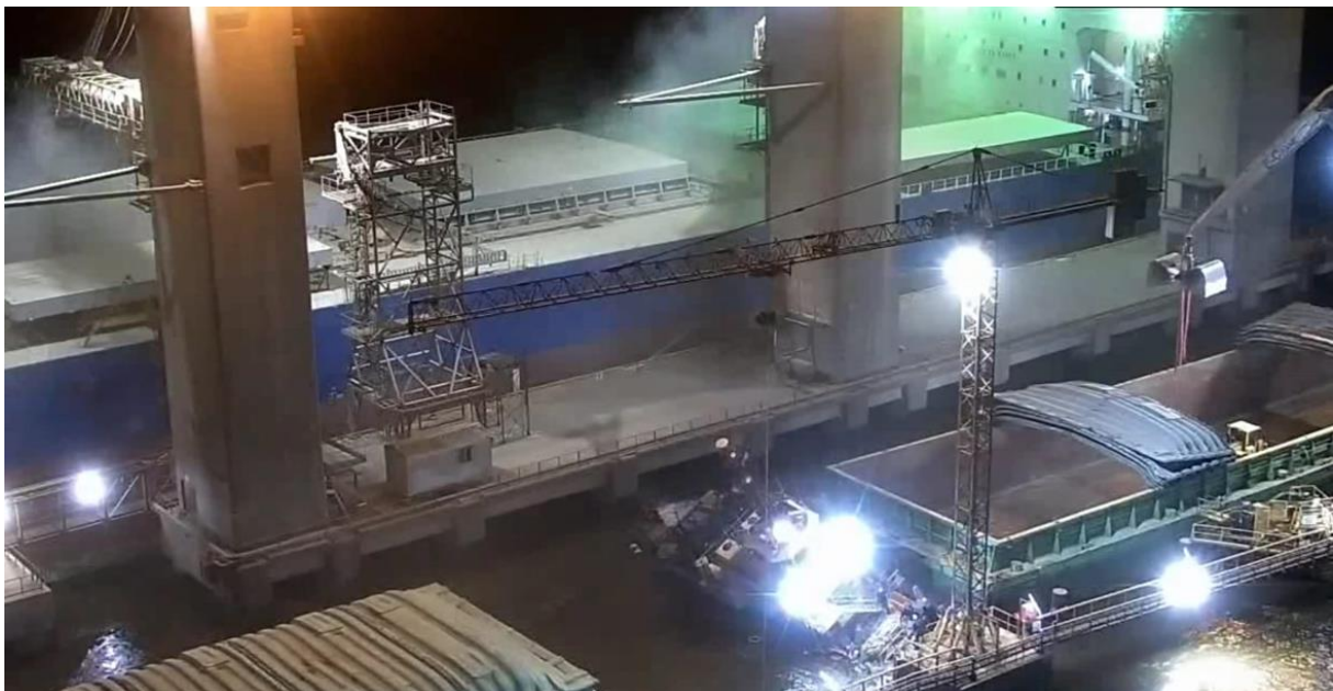
Figura 5. Escora de R/E Urano hacia la banda de estribor.
