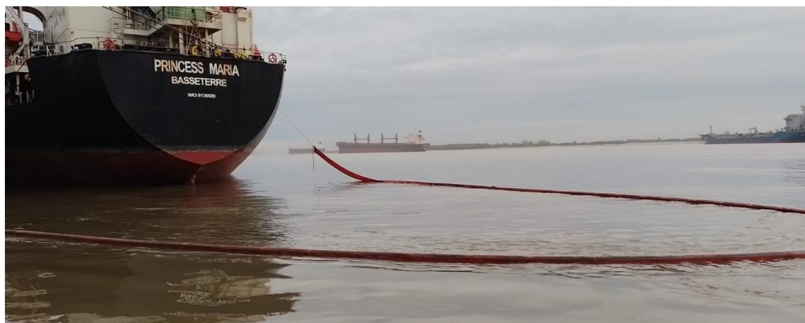
Figura 1. Se observa barrera de contención de derrames ubicada a popa del B/M Princess María.
