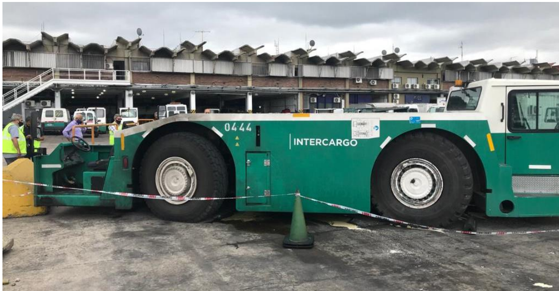
Imagen 4. Tractor de arrastre de aeronaves JTB-AeroTech B1200
