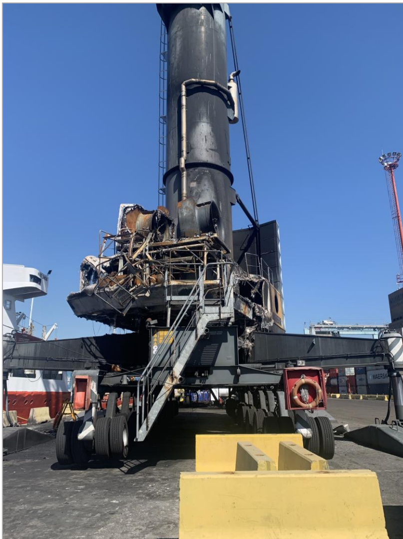
Figura 9. Vista de frente de los restos de la grúa incendiada.
