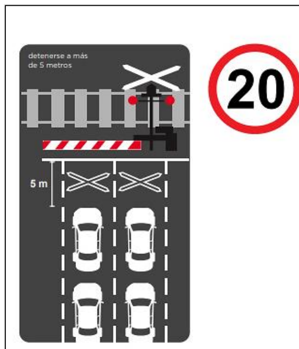
Figura 35. Indicaciones cruce de PAN ferroviarios. Fuente: Curso Nacional de Educación Vial Digital
