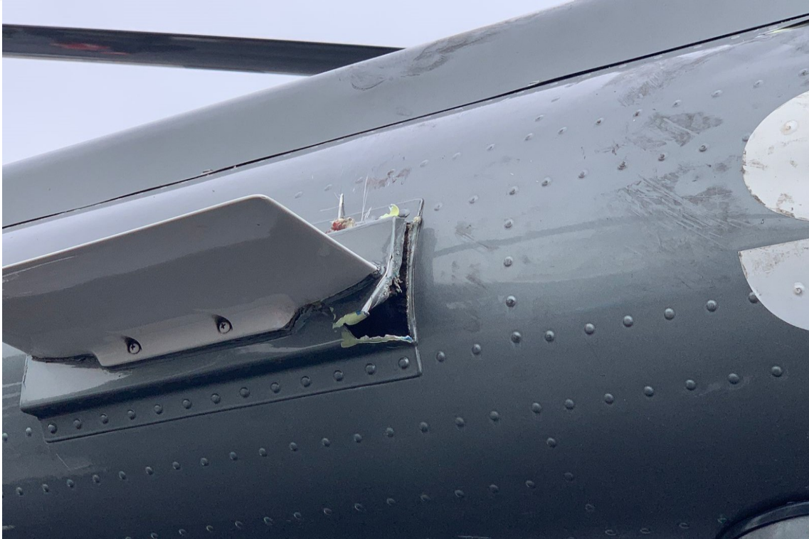
Figura 4. Daños en el cono de cola.
