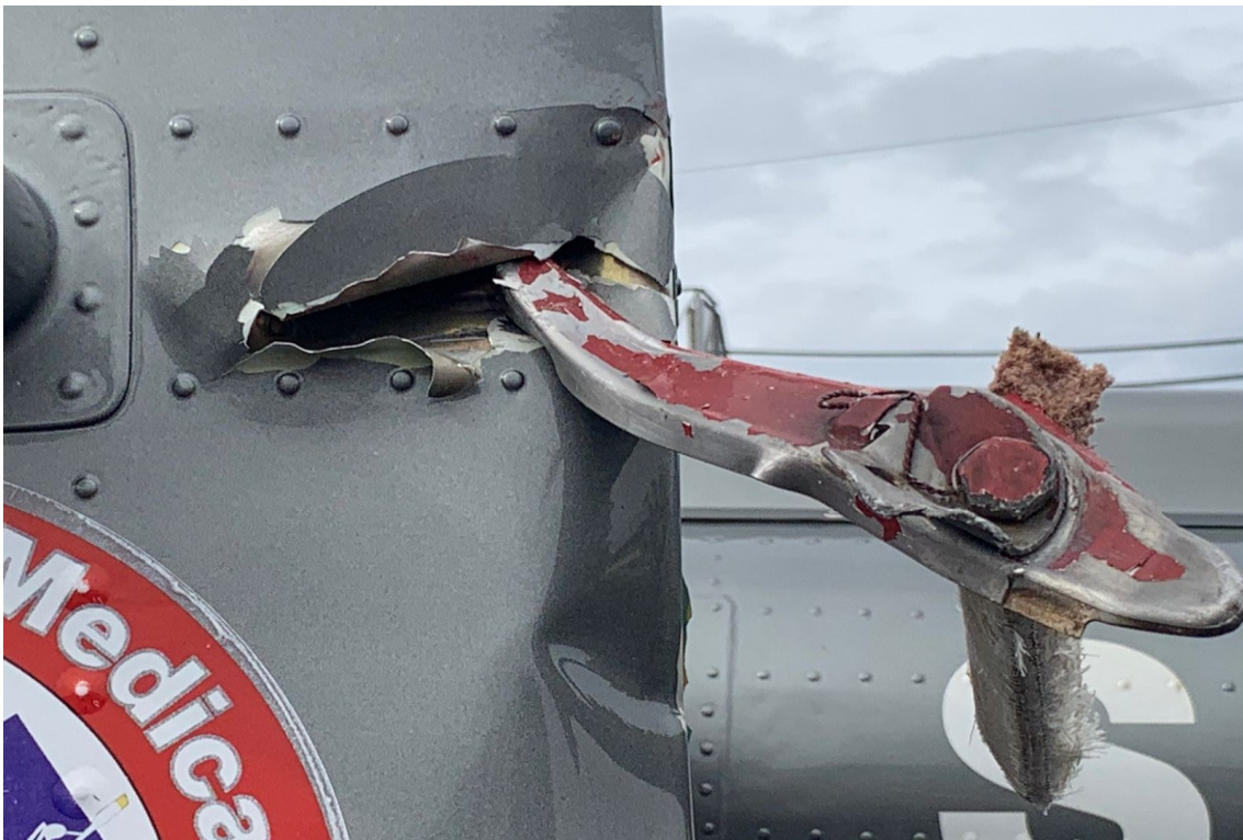
Figura 3. Daños en plano vertical del estabilizador de cola.
