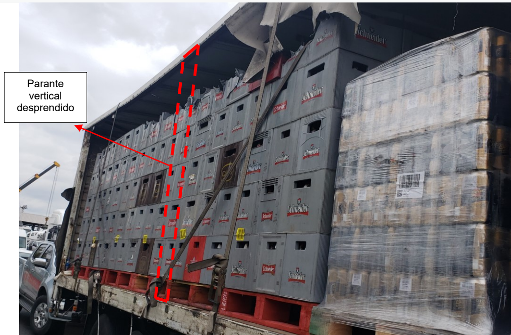
Figura 5. Daños en el lateral derecho del semirremolque. Se indica con líneas discontinuas color rojo la zona donde se encontraba el parante desprendido por el impacto de las palas del helicóptero. Obsérvese la carga dañada en el sector superior. Fuente: Archivo JST, edición propia.
