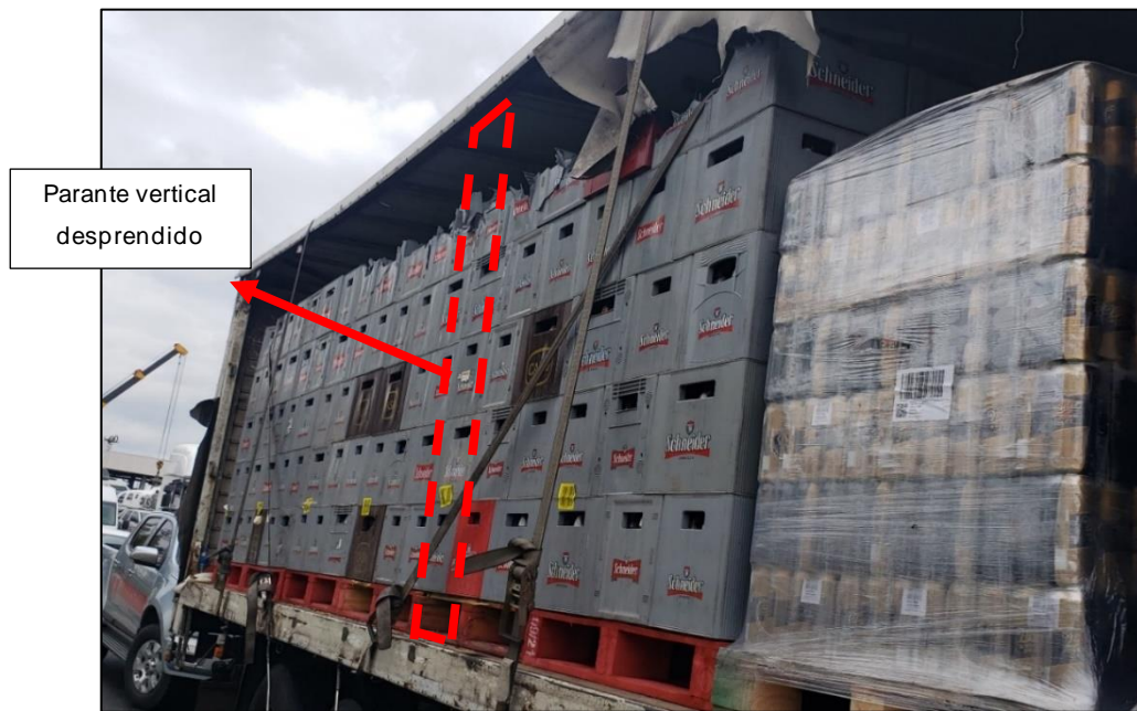
Figura 5. Daños en el lateral derecho del semirremolque. Fuente: relevamiento JST, 2021
