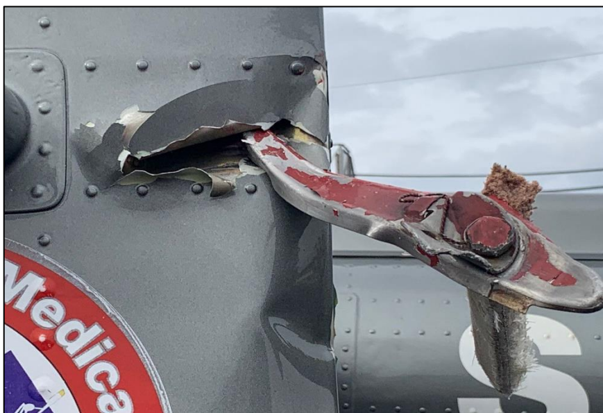
Figura 3. Daños en plano vertical del estabilizador de cola. Fuente: relevamiento JST, 2021
