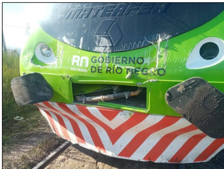
Figura 6. Daños en el sector frontal de la cabina del conductor. Fuente: TN , 28 de julio de 2022
