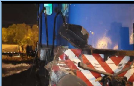
Figura 2. Acoplado del camión después de la colisión. Fuente: Medios
